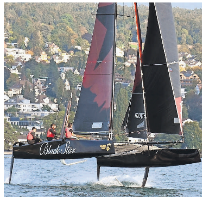
Dank Foils, Schwertern, die das Schiff aus dem Wasser heben, werden hohe Geschwindigkeiten erreicht.
