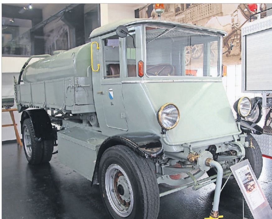
Rarität «made in Zürich». Dieser Elektro-LKW der Marke Tribelhorn spritzte Zürichs Strassen um 1920 mit Wasser sauber.
