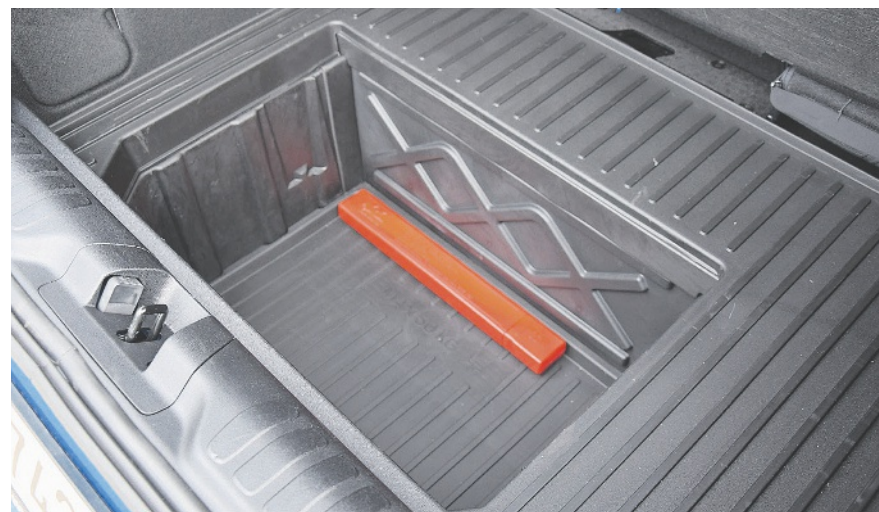
Clevere Lösung mit doppeltem Boden und Wasserablauf.
