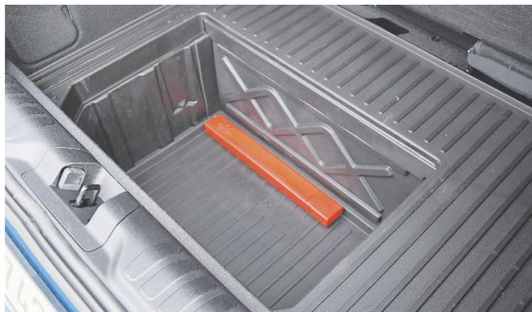
Clevere Lösung mit doppeltem Boden und Wasserablauf.
