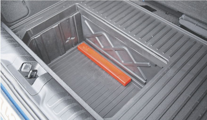
Clevere Lösung mit doppeltem Boden und Wasserablauf.
