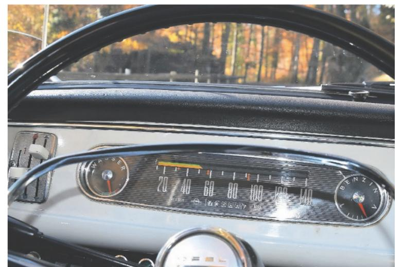
Geschwindigkeitsindikator mit wechselnden Farben.
