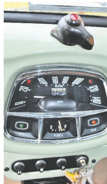
Über dem Instrument der Blinkerschalter.
