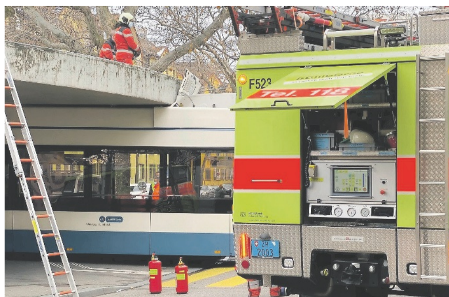
Das Akkupaket des Doppelgelenkbusses kollidierte mit dem Dach der Haltestelle. BILD ZVG
