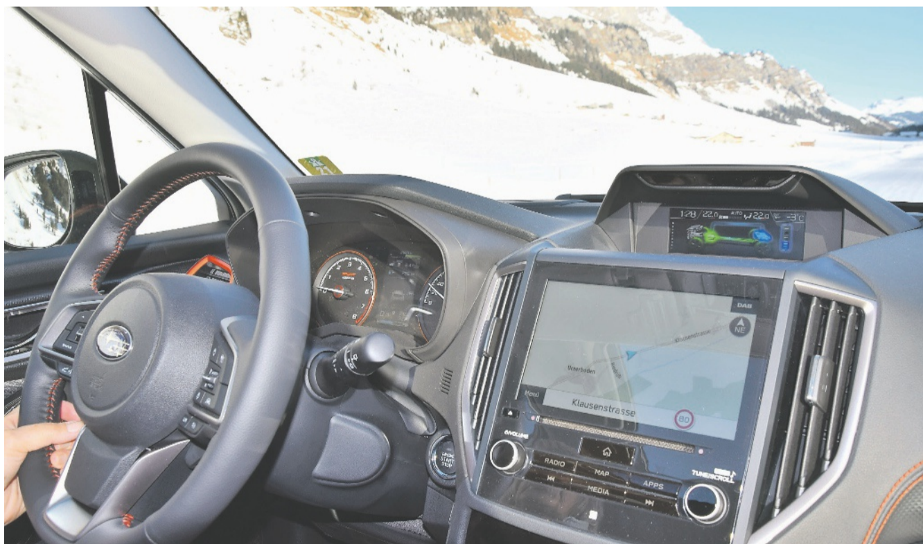
Sachliches Instrumentarium, angenehme Haptik, der kleine Bildschirm über dem grossen zeigt Energiefluss an.
