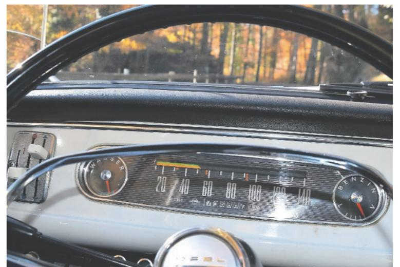
Geschwindigkeitsindikator mit wechselnden Farben.
