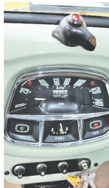
Über dem Instrument der Blinkerschalter.
